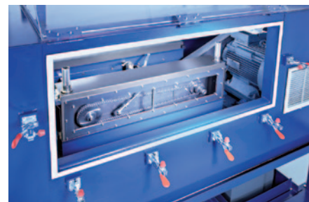
Etude du comportement à l'usure sur plus de 20 bancs d'essai ainsi que des tests adaptés aux besoins et aux applications de nos clients Verifica del comportamento di usura su oltre 20 banchi di prova con attrezzature specifiche per catene agricole
