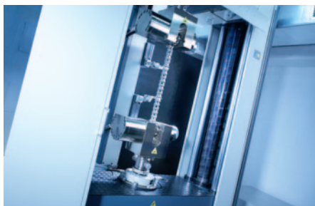
Détermination de la charge de rupture et de l'allongement jusqu'à 1000 kN Rilevamento del carico di rottura e dell'allungamento fino a 1000 kN
