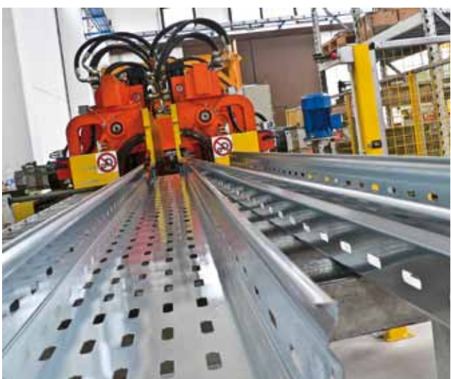
Reparto produzioni canali Manufacturing department duct
