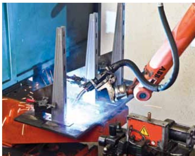
Reparto saldature eseguite con sistemi robotizzati Robotized welding department
