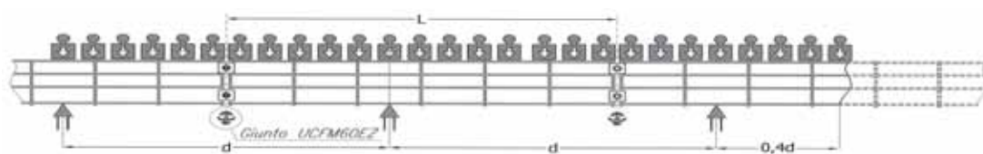
Diagramma di carico / Loading diagram Prova di tipo I [CEI EN 61537:2007-11]/ Test type I
