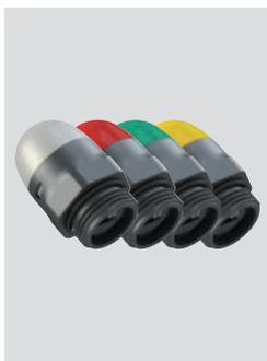
Questi segnalatori luminosi a LED vengono utilizzati per visualizzare la variazione di stato di un contatto elettrico posto all'interno dell'interruttore. Possono essere installati sugli interruttori avvitandoli su uno degli ingressi non utilizzati per il passaggio dei cavi elettrici. Per dettagli vedi pagina 436.
